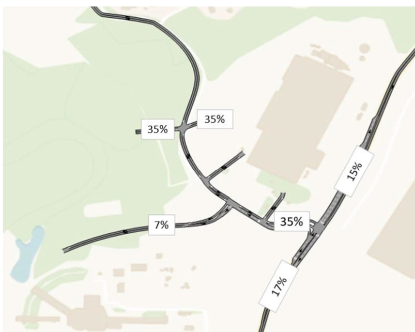
Figur 7. Andel tung trafik färdig etablering. Siffrorna avser andel tung trafik för respektive väg.
